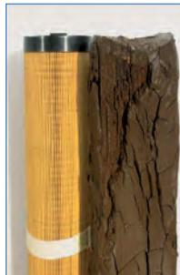
Heizsysteme mit Wasser als Wärmeträger leiden unter vielfältigen Schmutzproblemen! Hauptgrund ist aber Sauerstoffeinschluss im Heiz-/Kühlwasser.
